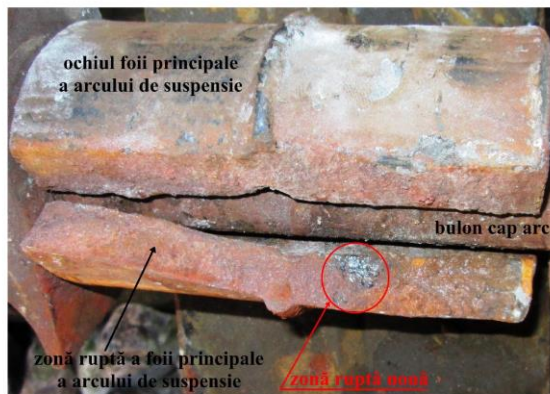
Fotografia nr.5 – Aspectul zonei rupte pe ochiul foii principale a arcului de suspensie
