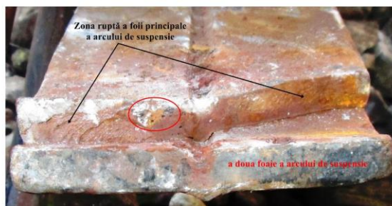
Fotografia nr.6 – Aspectul zonei rupte pe foaia principală a arcului de suspensie După preluarea, arcului de suspensie împreună cu ochiul foii principale și piesele atelajului de suspensie aferente, de la Postul de Poliție TF Ploiești Sud.
