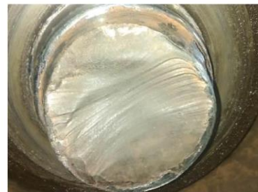
Foto nr.2 – secțiunea de rupere a fusului de osie
